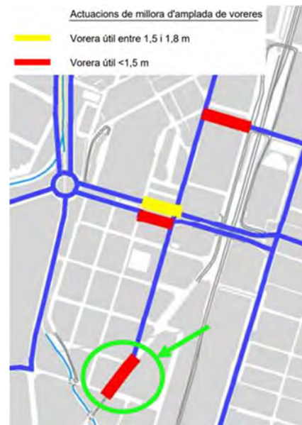
Figura 26: Actuacions de millora d'amplada de voreres a l'avinguda Sant Narcís entre Albacete i Can Pau Birol. Font: PMU Girona
