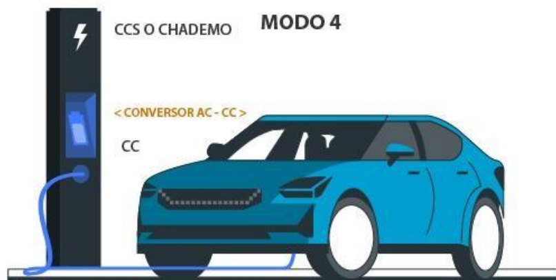
Figura 8. Tipus de recàrrega mode 4 (font: https://www.lugenergy.com/modos-de-recarga-vehiculos-electricos/ )
