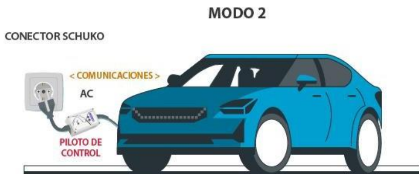
Figura 6. Tipus de recàrrega mode 2 (font: https://www.lugenergy.com/modos-de-recarga-vehiculos-electricos/ )
