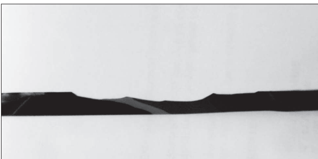
Cinta trencada durant el rebobinat.
