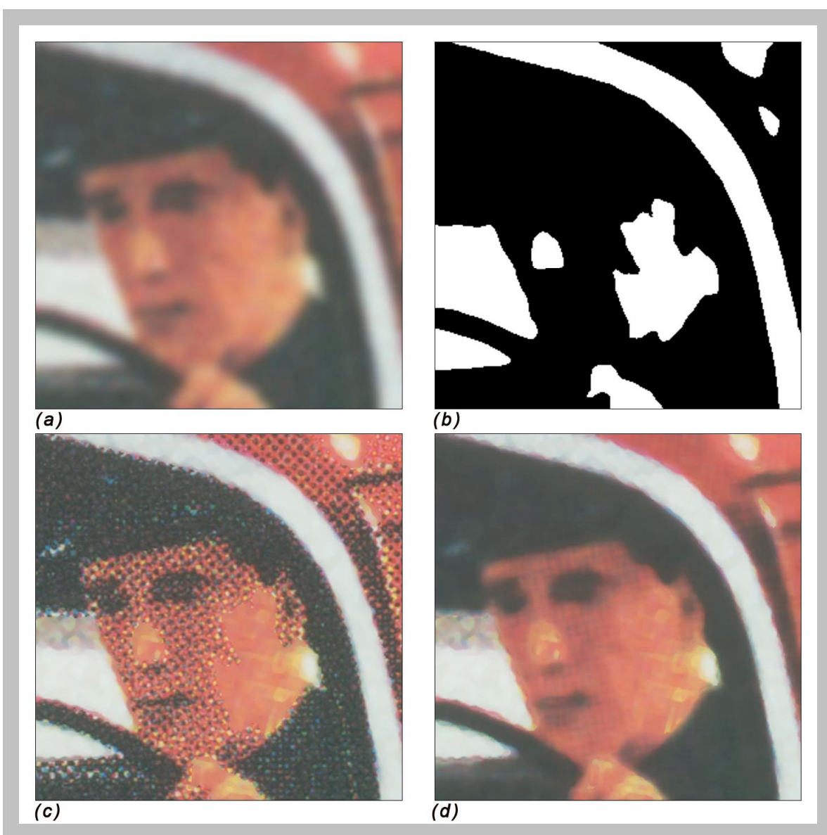
Figura 4. Aplicació de diferents filtres de mediana a dues àrees de la imatge original mostrada en la Figura 1. a) aplicació d'un filtre de Gauss per suavitzar i uniformitzar les diferents àrees de la imatge; b), llindar per separar les àrees clares de les fosques; c) reiteració de tres filtres de mediana de matriu 5 \times 5 a les zones clares. d) aplicació d'un filtre de mediana de matriu 11 \times 11 a les zones fosques de la imatge.
