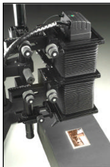
Fig., 4 – Dispositiu de reproducció. A la part superior es pot observar el respatller Sinarback22 acoblat a la càmera de banc òptic. A la part inferior, un autocrom original sobre la caixa Boxlite de flash electrònic que l'il·lumina per transmissió.
