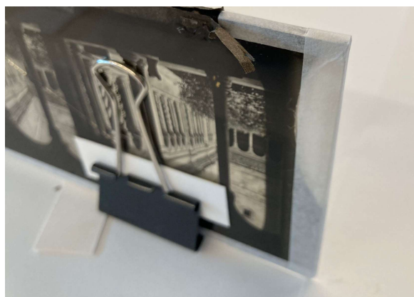
Figura 76. Aspecto de la zona reintegrada con PETG | CIAF0035.
