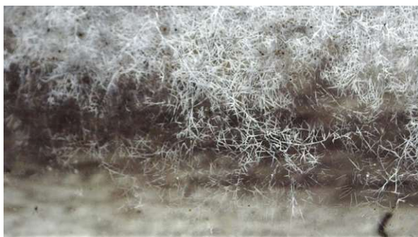
Figura 48. Grietas cercanas a la línea de marea (luz transmitida y magnificación x85) | CIAF0036.
