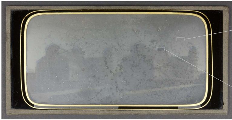
Figura 41. Deterioro químico avanzado en un vidrio protector (luz difusa sobre fondo negro) | CIAF0041.
